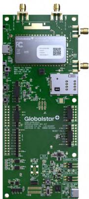
Un Kit de Desarrollo RM200M consiste en un módulo RM200M montado en un Shield Arduino Rev 3, junto con una antena Puck combinada de satélite y GPS. Este kit permite a los socios desarrollar y probar diseños tecnológicos antes de comprometerse con el hardware. El Kit de Desarrollo RM200M incluye 60 días de uso preautorizado de satélites. Además, los socios que opten por el Kit de Desarrollo, reciben un año de acceso al repositorio GitHub de Globalstar para el código fuente.
