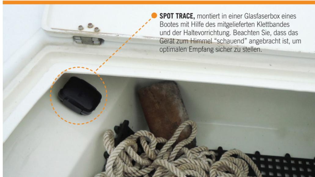
● **SPOT TRACE**, montiert in einer Glasfaserbox eines Bootes mit Hilfe des mitgelieferten Klettbandes und der Haltevorrichtung. Beachten Sie, dass das Gerät zum Himmel "schauend" angebracht ist, um optimalen Empfang sicher zu stellen.
