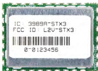
A Globalstar fornece o Transmissor Satelital STX3 para ajudar seus clientes a projetarem e construir dispositivos de comunicação compactos e eficientes. Usando a rede de satélites Globalstar, o STX3 permite que as informações sejam transmitidas de áreas bem além do alcance de cobertura celular confiável em todo o mundo.
