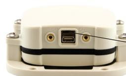
Soulever le capuchon et faire glisser l'interrupteur pour mettre en marche ou arrêter l'appareil
